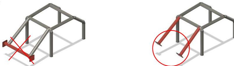
リアブレースのフレームへの取り付けは右の図のように取り付ける。
