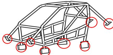
ロールゲージの取り付けはアンチホイールイントリュージョンを含めてボディーへの取り付けは8ポイントまでです。
