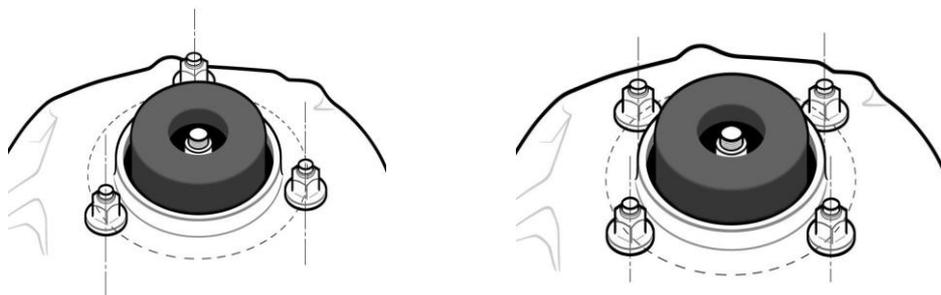
上の図マクファーソンストラットタワー アップアマウントの点線のサークルから外へはショックの取り付けをオフセットできません。
