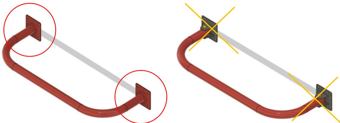
クイックリリース・ピンで取り付けられたバンパーは、スリーブ付きチューブで使用できます。クイックリリース・ピンは10mmまたはM10以上のボルトナットで固定することが必要です。
