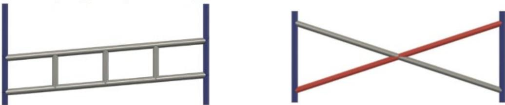
「X」を形成するとき、下の図のように2つのドアバーが交差しない場合は、少なくとも2つの垂直チューブを入れて下さい。垂直チューブは、上部ドアバーと下部ドアバーを接続するものとします。
